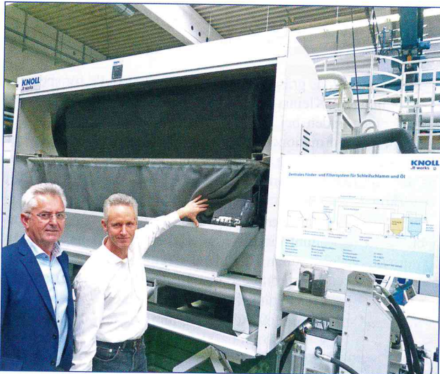
Abb. 4: Wolfgang Heidland (links), geschäftsführender Gesellschafter des gleichnamigen Gewebeherstellers, und Karl-Rudolf Vogel, Teamleiter Produktentwicklung bei KNOLL, geben den Blick auf das 12 m lange und 2 m breite Endlosfilterband frei.
